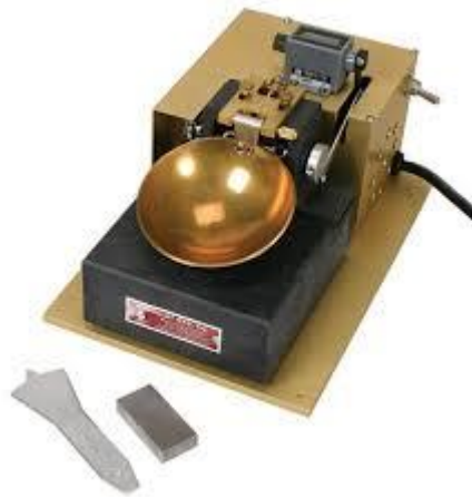
Figure 1 Matériels utilisés dans l'essai de limite d'Atterberg
