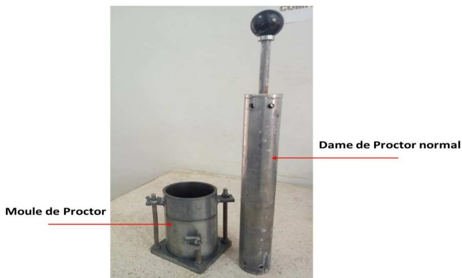
Figure 4 Moule et dame de l'essai Proctor normal
