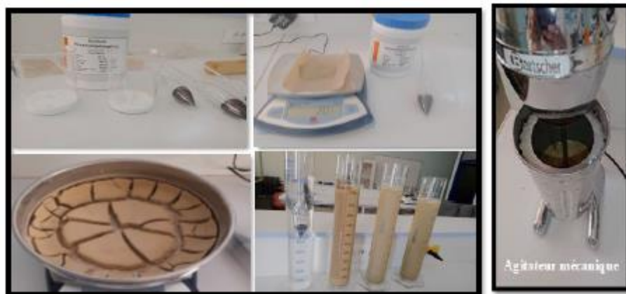
Figure 3 Matériel utilisé pour l'analyse granulométrique par sédimentométrie
