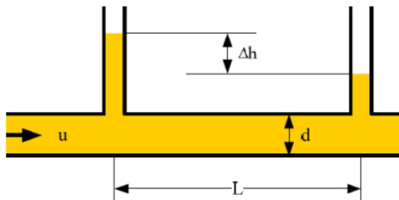
On constate que la hauteur du fluide est plus grande dans le tube amont que dans le tube aval. La différence des deux niveaux donne la hauteur de fluide correspondant à la perte de charge  $\Delta h$ . Les pertes de charge linéaires sont proportionnelles à la longueur  $L$  de la conduite, inversement proportionnelles à son diamètre  $d$ , proportionnelle au carré de la vitesse débitante  $V$  du fluide. Elle est calculée par la formule de Darcy – Weisbach :
