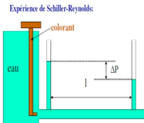
Aux faibles vitesses: le filet coloré conserve son individualité jusqu'à l'extrémité du tube, il ne se mélange pas aux autres filets de fluide: l'écoulement est dit laminaire. La perte de charge est faible.
