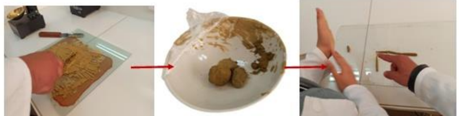
Figure III.4 Mode opératoire de l'essai de limite de Plasticité au laboratoire du CUM
