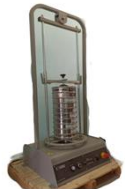
Figure II.3 Mode opératoire du Tamisage (gravier) au laboratoire du CUM
