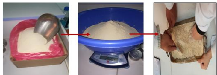
Préparer le sol sec dont le diamètre des particules <5mm
