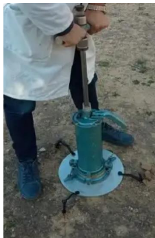
Figure V.7 Mesure du volume de la cavité et lecture de V_1 .
