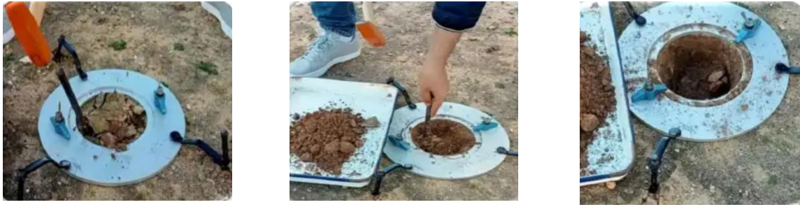
Figure V.6 Excavation de la cavité
