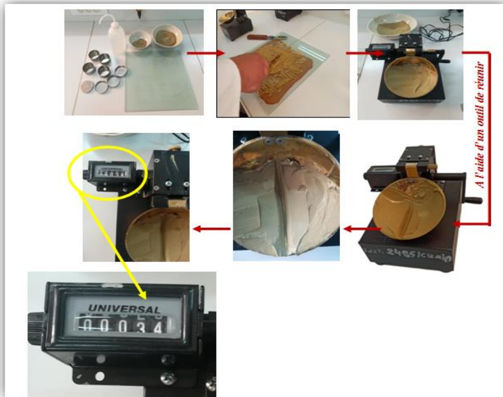
Figure III.3 Mode opératoire de l'essai de limite de liquidité au laboratoire du CUM
