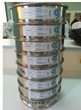
Figure II.3 Mode opératoire du Tamisage (gravier) au laboratoire du CUM
