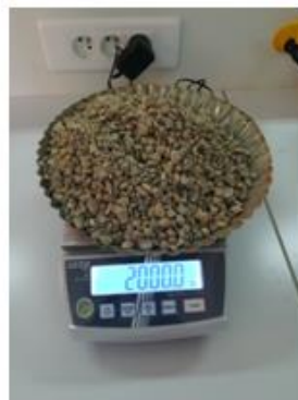
Figure II.3 Mode opératoire du Tamisage (gravier) au laboratoire du CUM
