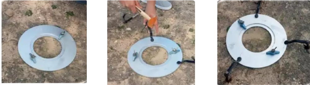
Figure V.4 Fixation de la plaque d'appui sur la surface préparé du sol.
